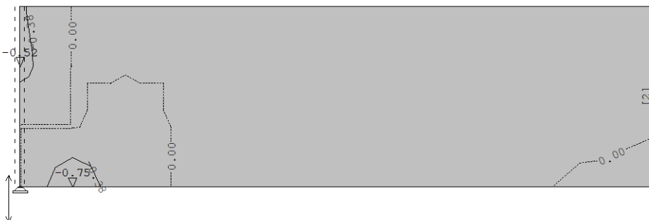
Slika: Potrebna armatura stubišta – donja i gornja zona
